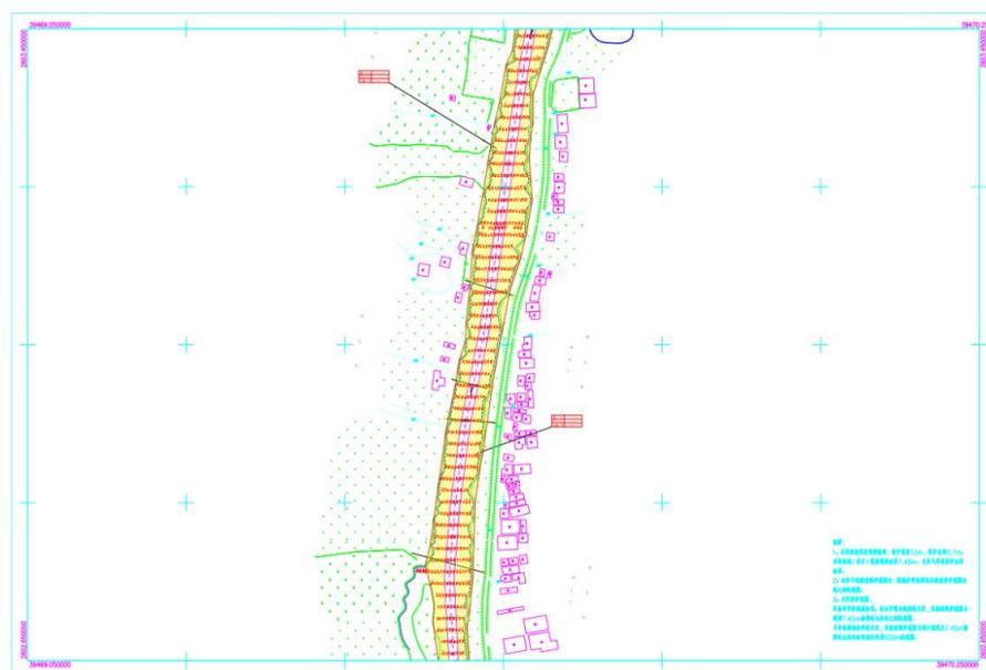
图 3-3 河网地区限制性航道（运河航道）保护范围示例
